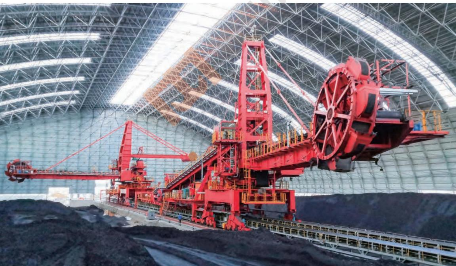
堆取料机 Stacker-reclaimer
